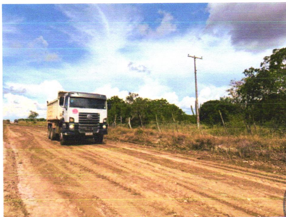
Foto 6 - TRANSPORTE COM CAMINHÃO BASCULANTE DE 10 M 3 , EM VIA URBANA EM LEITO NATURAL (UNIDADE: M3XKM). AF_07/2020
